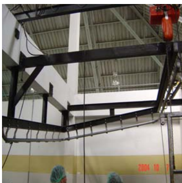
<- ระบบคานและราวแขวนช่วง แท่งคอกไปยังอ่างลวกและปั้นขน สุกรอัตโนมัติ ->
