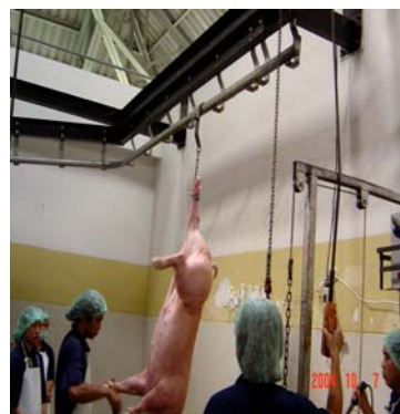
<- ระบบคานและราวแขวนช่วง แท่งคอกไปยังอ่างลวกและปั้นขน สุกรอัตโนมัติ ->
